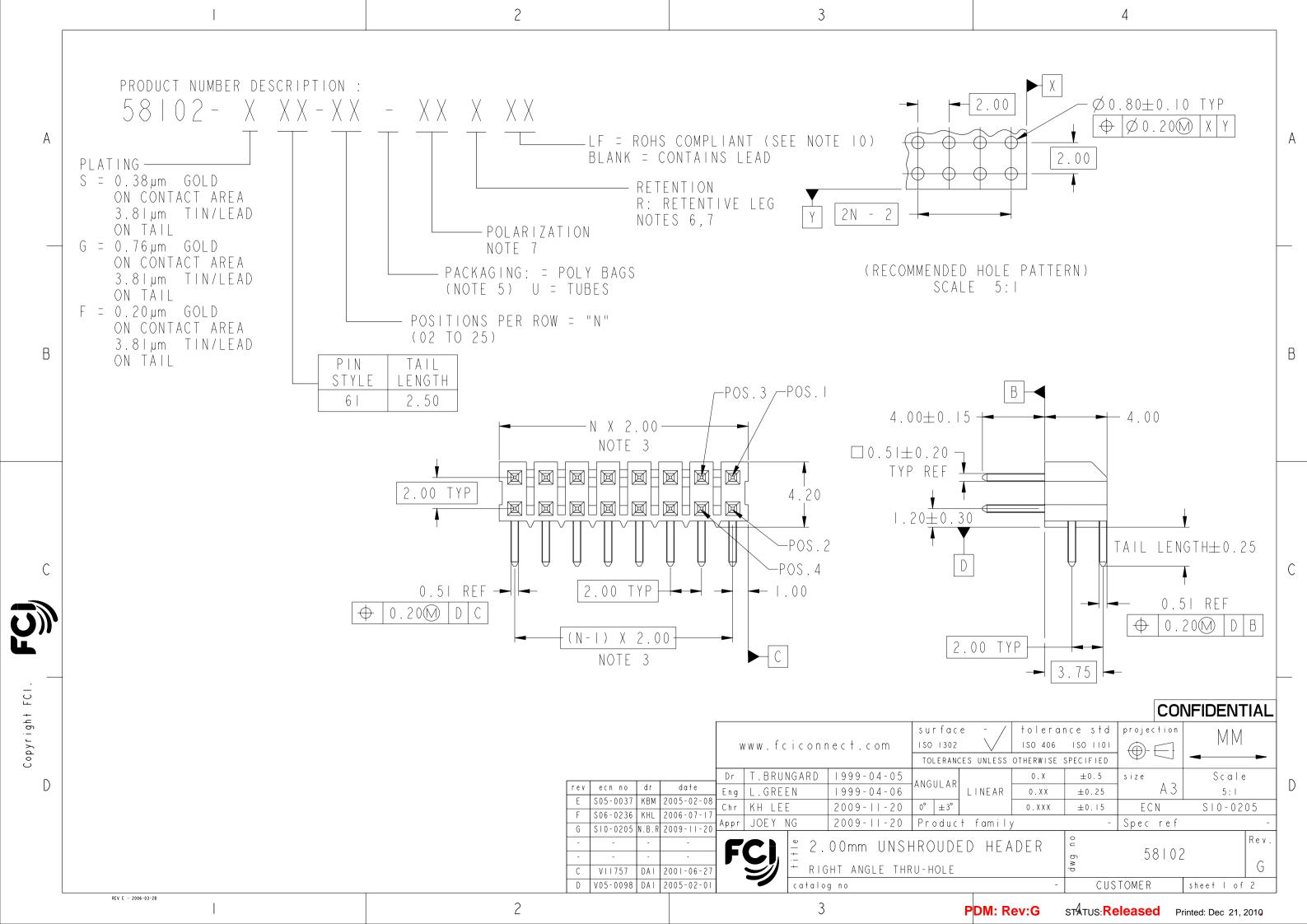
(I) MATERIAL HOUSING:HIGH TEMP.THERMOPLASTIC UL 94V-0.COLOR BLACK
